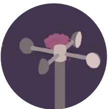
Мы можем измерить скорость ветра анемометром. Ветер дует на верхнюю часть анемометра, та вращается, устройство вычисляет скорость вращения и преобразует ее в скорость ветра. Мы можем измерять направление ветра с помощью флюгера. Флюгер также вращается и указывает направление ветра.
